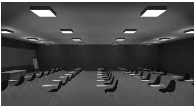
Figura 5.6 Esempio di illuminazione mediante apparecchi a sospensione a soffitto di tipo diretto-indiretto. La luce risulta in questo caso più morbida
