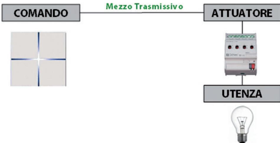
Figura 1.1. Meccanismo di funzionamento di un impianto di domotica
