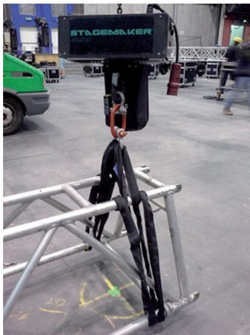
Figura 4.7 Punto di sospensione su una truss
