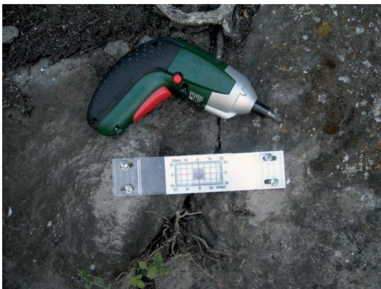
Figura 3.31. Fessurimetro composto da due piastre sovrapponibili in materiale plastico, con croce di lettura e griglia di misura. Lo strumento è stato infisso, mediante viti inossidabili, a cavallo di una frattura che attraversa dei litotipi tufacei
