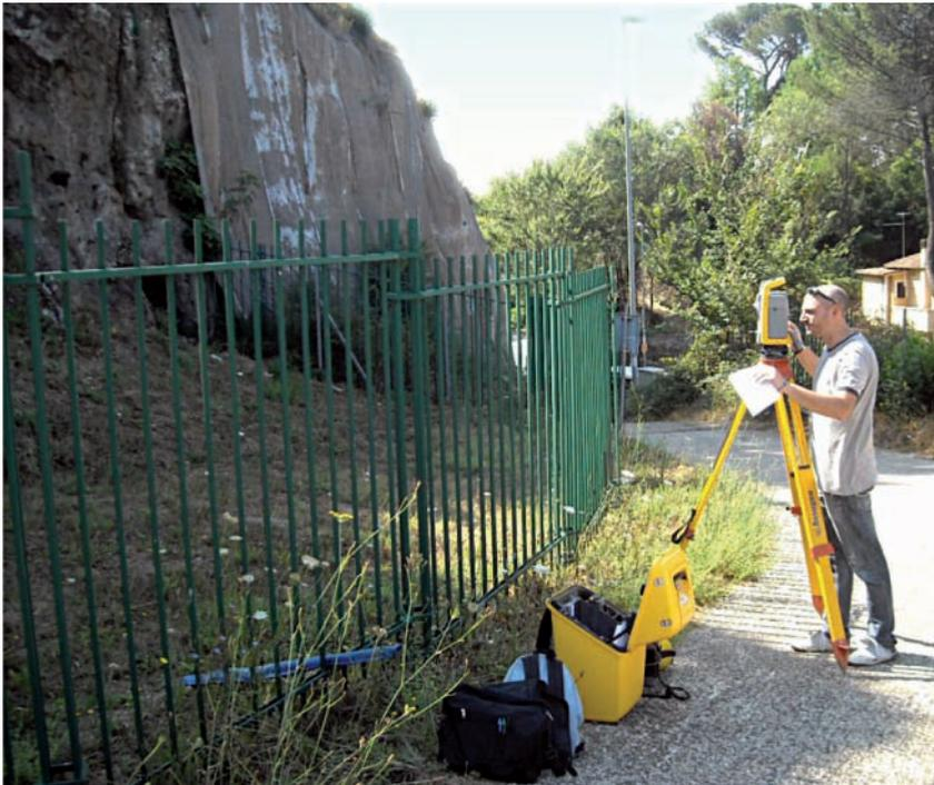
Figura 3.34. Rilievo topografico di una parete rocciosa eseguito con una stazione totale automatica con distanziometro laser (località Prima Porta, Roma) (foto di F. Gaeta)
