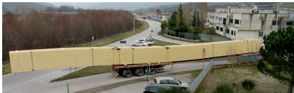
Figura 1.21. Trasporto eccezionale da 40 m di travi in legno lamellare
