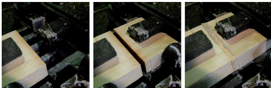
Figura 1.6. Sequenza dell'operazione d'incollaggio del finger joint
