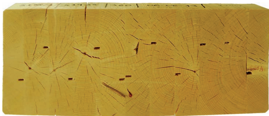
Figura 1.19. Campione sottoposto ad un ciclo della prova di delaminazione con esito positivo. Sono evidenti le fessure da ritiro, ma l'unica apertura sulla zona di colla (al centro fra le ultime lamelle a destra) è in corrispondenza di un nodo e non se ne tiene conto ai fini del superamento della prova
