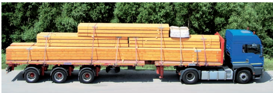
Figura 1.20. Carico su bilico con semirimorchio allungabile di travi in legno lamellare. Il cassone può essere allungato per raggiungere la dimensione delle travi caricate ed evitare sporgenze
