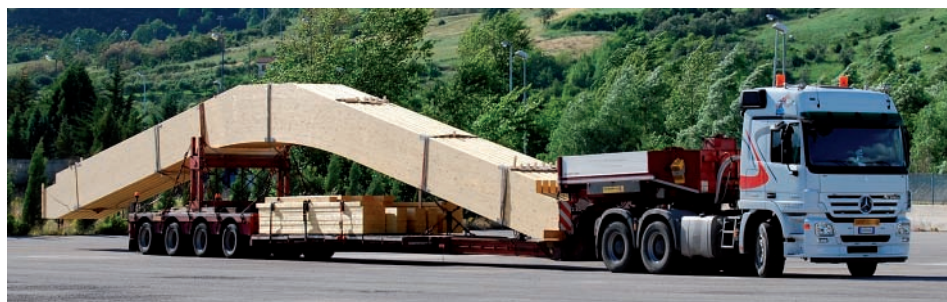
Figura 1.22. Trasporto eccezionale di travi bifalda curve in legno lamellare. Il cuneo in sommità delle travi è stato rimosso per consentire la trasportabilità e verrà ripristinato in cantiere
