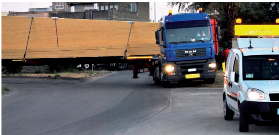
Figura 1.23. Trasporto eccezionale di travi in legno lamellare da 34 m, in transito all'interno di un paese per raggiungere il cantiere
