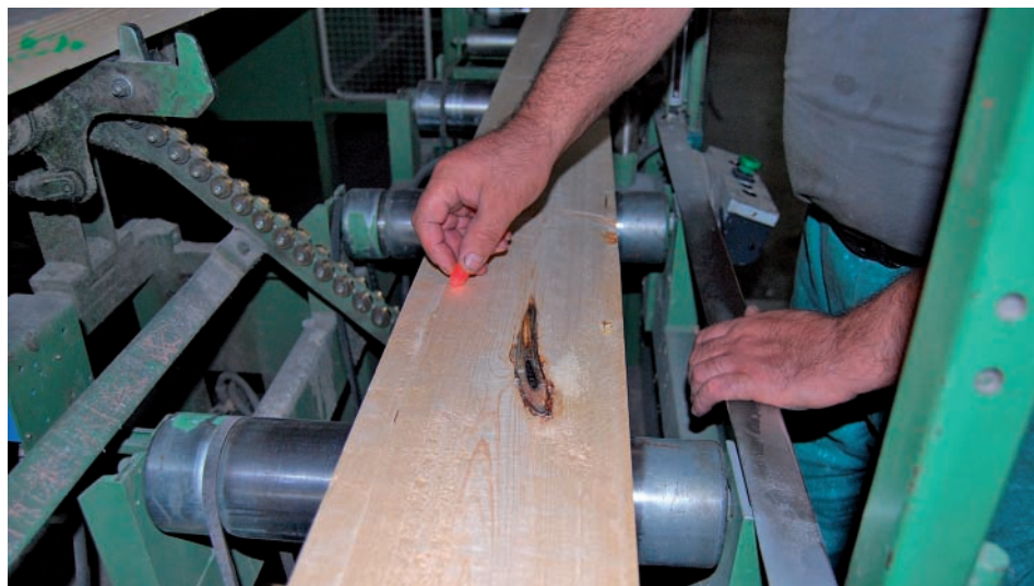
Figura 1.4. Individuazione dei difetti in una tavola destinata all'incollaggio di un elemento in legno lamellare; l'operatore segna la porzione che verrà scartata da una macchina dotata di controllo ottico
