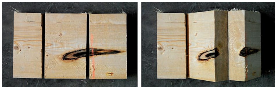
Figura 1.5. Scarto con difetti di una tavola
