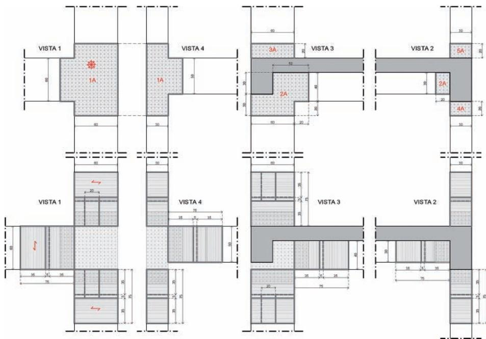
Figura 3.15. Nodo d'angolo "A": dettaglio esecutivo del rinforzo. In alto: disposizione del tessuto CFRP quadriassiale. In basso: disposizione delle fasciature CFRP uniassiali. Prospetti
