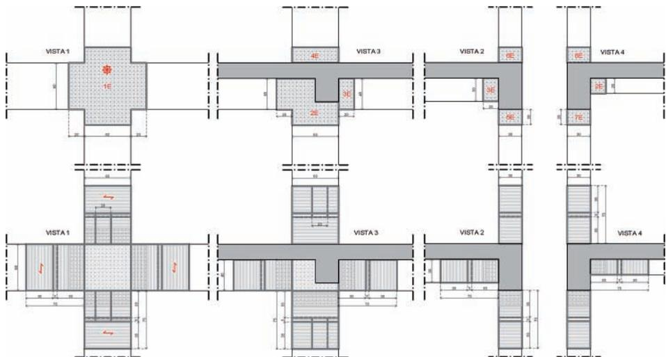
Figura 3.17. Nodo esterno "E": dettaglio esecutivo del rinforzo. In alto: disposizione del tessuto CFRP quadriassiale. In basso: disposizione delle fasciature CFRP uniassiale. Prospetti
