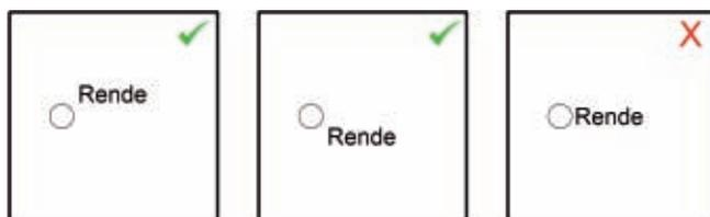
Figura 4.2. Un'etichetta al fianco di un punto dovrà sempre essere spostata leggermente verso l'alto o verso il basso; sono da evitare etichette perfettamente allineate al punto
