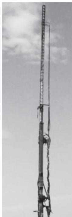
Figura 6.3. Particolare antenna da *jet-grouting* con prolunga
