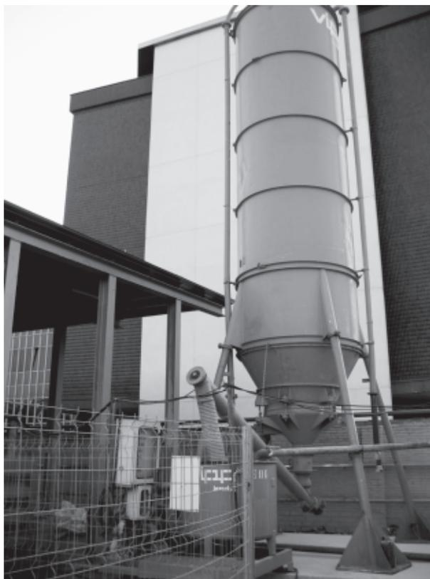
Figura 1.2. Impianto miscelazione bentonite
