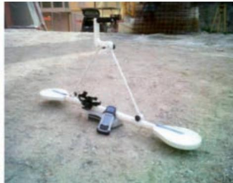
Figura 4.52. Area di lavoro. Particolare dell'elettromagnetometro EMP-400 Profiler durante le fasi di calibrazione (immagine concessa da GeoStudi Astier srl, [www.geostudias-tier.com](http://www.geostudias-tier.com))
