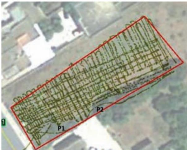
Figura 4.13. Area di lavoro. Il poligono rosso individua l'area all'interno della quale sono state effettuate le misure FDEM; le linee gialle illustrano la posizione GPS delle linee di acquisizione. P1 e P2 rappresentano la posizione di vegetazione arborea che ha parzialmente impedito l'acquisizione dati
