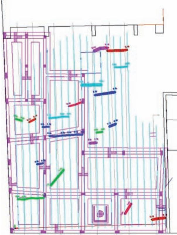
Figura 4.51. Area di lavoro. In magenta sono evidenziati gli elementi strutturali della futura costruzione; in azzurro sono evidenziate le posizioni delle linee di acquisizione dati (immagine concessa da GeoStudi Astier srl, [www.geostudias-tier.com](http://www.geostudias-tier.com))
