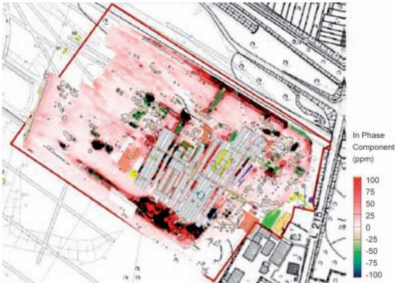
Figura 4.11. Risultati FDEM. Mappa della componente in fase con dipoli orizzontali co-planari posti a 6 m di distanza (immagini concesse da Patberg e Schrameck, [www.psingenieure.eu](http://www.psingenieure.eu))
