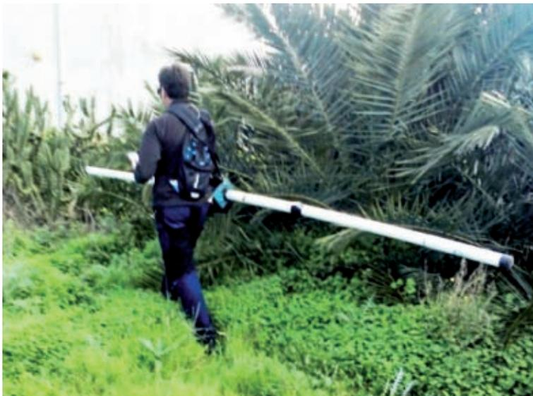
Figura 4.14. Fase di acquisizione dati FDEM con Geonics EM31
