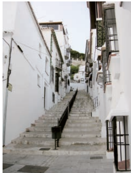
Figura 3.9 Strade strette, orientate rispetto alla direzione prevalente dei venti e costeggiate da una cortina continua di edifici con pareti intonacate di colore chiaro (Ronda, Spagna)
