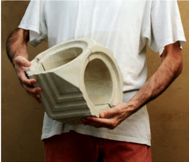
Figura 5.6. Elemento di accumulo termico in refrattario con carburo di silicio applicabile sia in alcuni inserti-camino idonei all'utilizzo con alta temperatura sia per la creazione di girofumi nelle classiche stufe ad accumulo. Sul mercato sono disponibili vari elementi (diritti, curvi, con tappo di ispezione, ecc.) in modo da dare al tecnico fumista piena libertà di realizzazione (fonte: FuocoStufeCamini)
