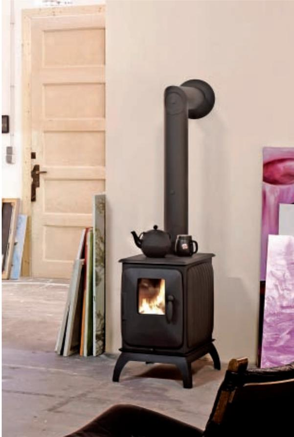
Figura 5.7. Stufa in ghisa di elevata qualità che, malgrado le sue ridotte dimensioni, si caratterizza per una discreta massa (130 kg) e quindi per un certo accumulo di calore (fonte: Brunner-N&N Alpfire)
