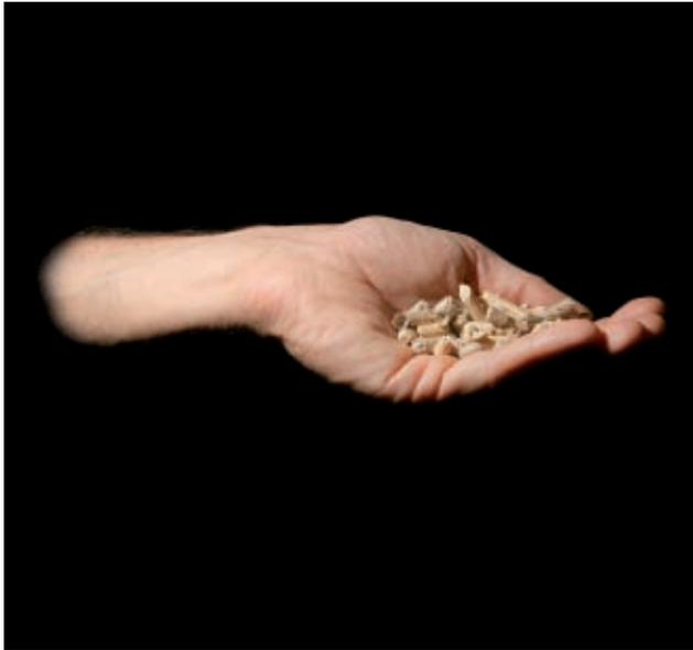
Figura 1.3. Pellet di legna: un combustibile di facile reperibilità sul mercato. I sistemi a pellet si caratterizzano per un livello elevato di automazione includente spesso l'accensione automatica del fuoco (fonte: QualitàEdilizia)
