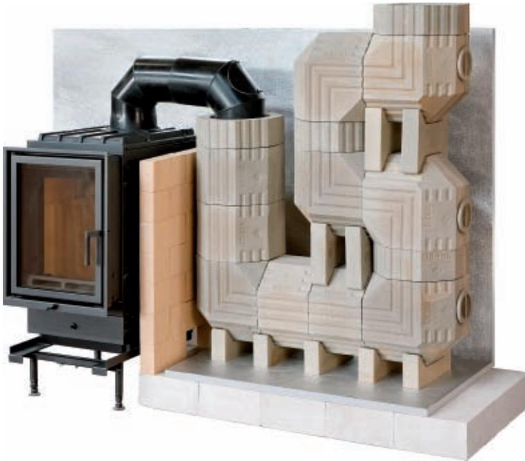
Figura 9.12. Schema di corpo interno di stufa ad accumulo con inserto dotato di sportello con vetro e girofumi realizzato con elementi prefabbricati in carburo di silicio. Il tutto è poi esternamente rivestito con strato antemurale in maiolica, refrattario intonacato o altro materiale con funzione sia estetica che di accumulo termico (fonte: Cerampìù)
