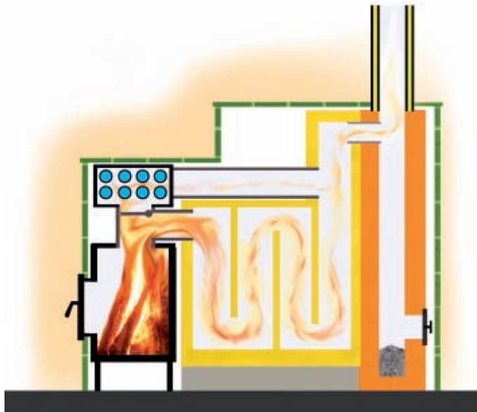
Figura 9.8. Schema di stufa ad accumulo con inserto in ghisa. Nell'immagine, la stufa è in modalità "riscaldamento ambiente" o modalità "stufa", come si può notare dall'esclusione dello scambiatore mediante apposita valvola (fonte: FuocoStufeCamini)
