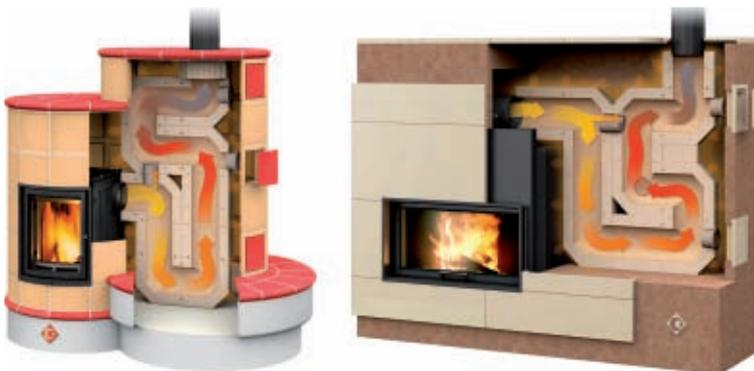
Figura 9.13. Esempi di utilizzo di elementi prefabbricati in argilla e carburo di silicio. A sinistra collegamento con inserto in stufa in maiolica. A destra, soluzione per camino-stufa ad accumulo dal design moderno (fonte: Cerampìù)
