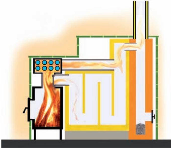
Figura 9.7. Schema di stufa ad accumulo con inserto in ghisa. Nell'immagine la stufa è in modalità "riscaldamento acqua" o "modalità caldaia", come si può notare dall'esclusione dei fumi mediante apposita valvola (fonte: FuocoStufeCamini)
