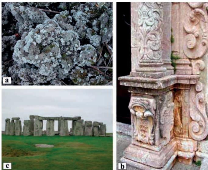
Figura 1.22 Esempi di biodeterioramento: a) Colonizzazione di rocce basaltiche da parte di muschi e licheni (Vulcano Etna – Catania); b) Alterazione cromatica e corrosione da parte di batteri e radici di piante (Chiesa di S. Maria all'Aracoeli – San Marco d'Alunzio); c) Coperture vegetali sue rocce megalitiche (Stonehenge)
