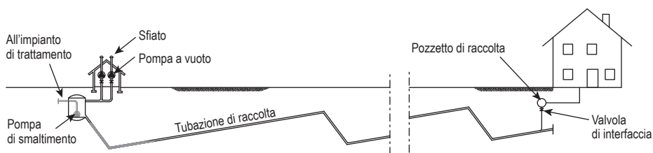
Figura 1.4. Schema di fognatura a vuoto
