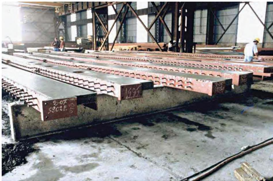
Figura 1.21 - Travi composte partially encased: getto del calcestruzzo in stabilimento.
