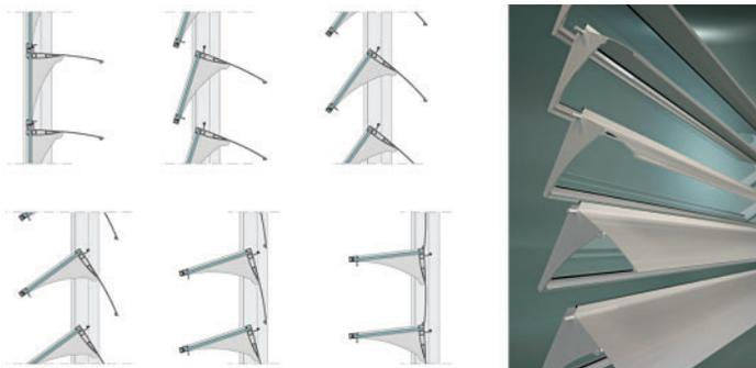
Figura 2.6. Foto schermature integrate nel sistema vetrato (fonte: Lilli System)
