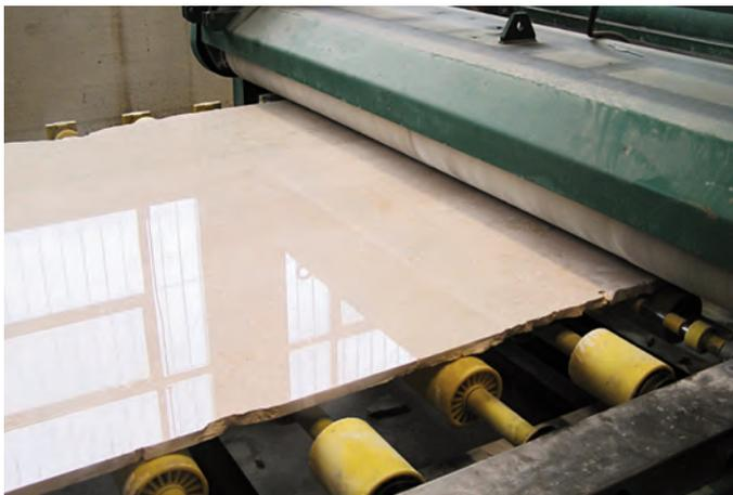
La stessa attrezzatura viene impiegata per ottenere una superficie levigata della lastra interrompendo il processo di lavorazione prima di installare gli abrasivi a grana più fine; tale procedura porta ad avere una superficie priva di irregolarità superficiali, liscia, uniforme ma non lucida (finitura levigata). Più specificamente, utilizzando abrasivi a grana diversa si possono ottenere la finitura opaca, satinata, semilucida, levigata grossolana, levigata media e levigata fine.
