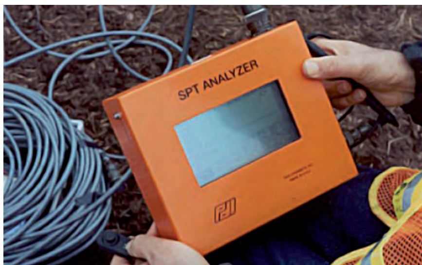
Figura 2.6 SPT analyzer (da Aggour e Radding, 2001)
