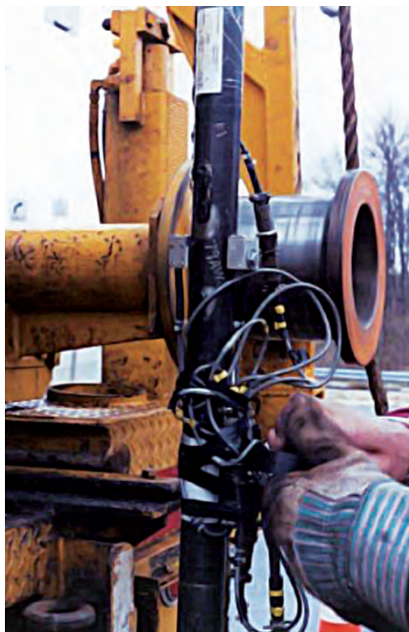
Figura 2.8 Particolare dell'asta strumentata
