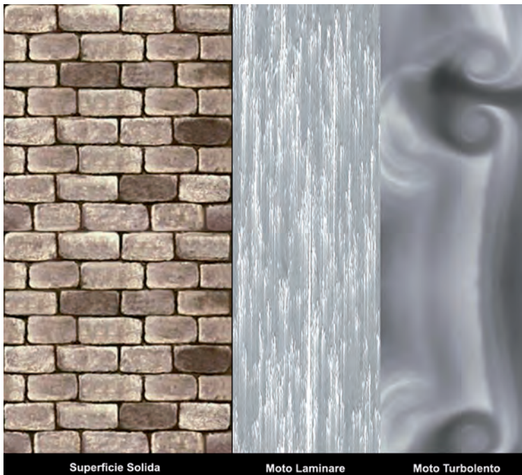
Figura 1.1 Moto laminare e moto turbolento
